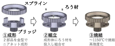
図1 焼結接合キャリアの構成
