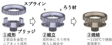
図1 焼結接合キャリアの構成
