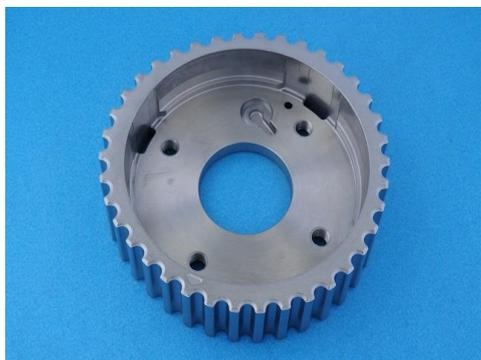
本製品は、3 気筒エンジンに搭載される VTC 部品で低振動化を目的とした非円形三角おむすび型のプーリーです。機能向上のために構成部品には複雑な形状と高い寸法精度が要求されており、精度面では外径 100mm の非円形外歯に極めて高い幾何公差が、形状面では組み付け性を考慮した雌ネジ穴や油の通る長穴などが、生産面では将来的なグローバル生産が求められています。これら課題に対し、デザインインによる形状検討と製造条件の最適化により高精度非円形プーリーの量産化に成功しまし
