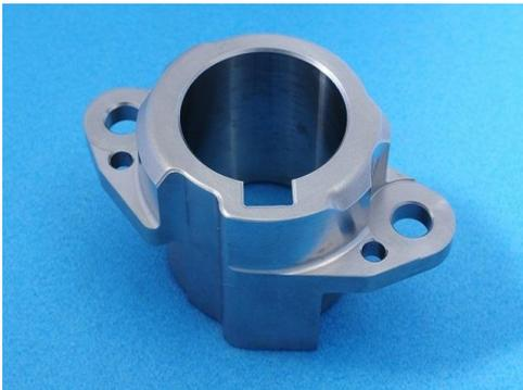
本製品は、ガソリン直噴エンジンの昇圧機構に使用されるガイドリフターです。この昇圧機構は将来的にグローバルで月産 15 万台のエンジンへの横展開が計画されていることから各 부품のコスト低減が積極的に検討されました。本製品の要求仕様を満たす最適な材質と製造工程を選択した上で加工代を最大限減らし、30%低減というコストメリットから鋳造品からの切り替えに成功しました。
