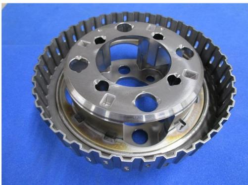
本製品は、新多段 AT 向けラビニョキャリアです。焼結化を前提にユニット構造と合わせて設計することで、鍛造/プレス品で構成されていたラビニョキャリアの焼結化を実現し、コスト削減につなげました。平均密度を  $7.05\text{g/cm}^3$  とし、応力集中部位の形状最適化と肉厚確保等、粉末成形の自由度を生かした形状設計を実施することでキャリアの負荷応力を疲労限度まで抑えています。キャリアの脚部の段付形状については、量産性を考慮しトータルコストの観点から成形体加工を
