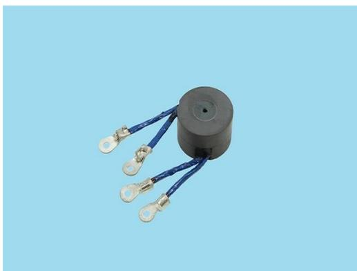
本製品は、アモルファス磁性材料を用いたハイブリッドコアです。医療機器（たとえばMRIなど）の高性能化に伴い、電源回路のチョークコイルは数kW級以上の大電流・大電力化の傾向にあります。従来の磁性材料は磁気飽和しやすいため、大電流化の対策として大きな体積を必要としていました。また機器の高速動作要求からこれらの用途に用いられる回路の駆動周波数の高周波数化が進んでいますが、従来材料は高周波数ではインダクタンス値や鉄損などの特性低下が起こるといった欠点もありました。これら大電流、高周波用途と小型化を両立させるために、内側にアモルファス圧粉材料、外側にアモルファス射出材料を使用したハイブリッドコアを開発しました。アモルファス射出コア単独ではインダクタンス絶対値が不足し、アモルファス圧粉コア単独では直流重畳特性を満足しなかったため、両者をハイブリッド構造とすることでこれらの要求特性を満足させる
