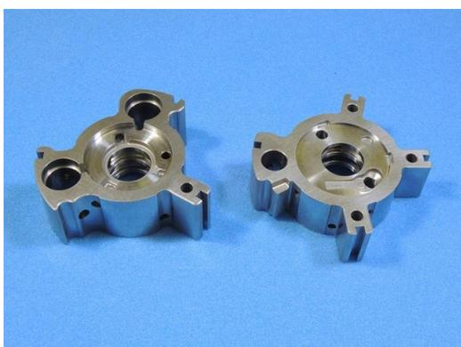
本製法は、VVT 部品の穴と横穴を同時成形加工と品質を確保するために成形体への2次元バーコードを付与実現し、かつ成形からサイジングまでタッチレスとした製造ラインです。
