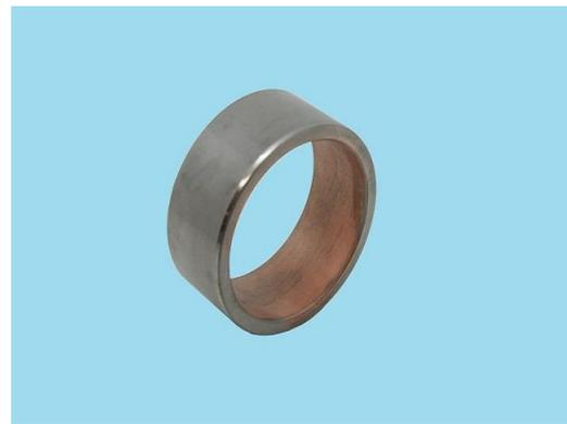
本製品は、建設機械(例えば油圧ショベル)の関節部に用いられる軸受です。使用条件は、低速・高荷重で、かつ振動・衝撃等が作用する厳しい環境下で低摩擦・耐摩耗が求められます。従来量産していた焼結含油軸受は、材質が摺動性と高硬度を両立する材料であり、製造は「強度・硬度を確保するための熱処理」、「寸法精度を確保するための切削加工」を採用しています。従って、材料と製造の両面で高コスト、また性能面では熱処理しているため脆く衝撃値が低下し割れの恐れがありました。この課題を解決するにあたって次のような2層構造としました。まず内層(軸受側)は耐摩耗性向上のため、Fe-Ni-Mo-C系合金鋼としました。また、摺動性向上と内径切削加工廃止のためCu添加し、サイジングでの矯正を可能にしました。外層は、高強度、高
