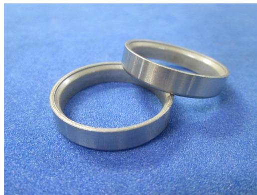
本材料は、微細硬質物をマトリックス中に分散させて、耐凝着摩耗性を向上したバルブシート用材料です。エンジンに使用されるバルブシートは、高い耐摩耗性を要求されており、その対応として従来から硬質粒子を添加しマトリックスに点在させ、その敷石効果により高い耐摩耗性を実現しています。またエンジン使用中の燃焼熱によりバルブシート表面にFeを主成分とした酸化物が生成し、それがバルブとの耐凝着摩耗に効果を発揮して、硬質粒子との相乗効果でその性能を発揮しています。しかし、近年エンジンの高効率化に伴い、燃料の完全燃焼化率が高まり、Fe系酸化物を生成する条件が厳しくなっている為、凝着摩耗に対してバルブシートを強化する必要性がありました。高い耐凝着摩耗
