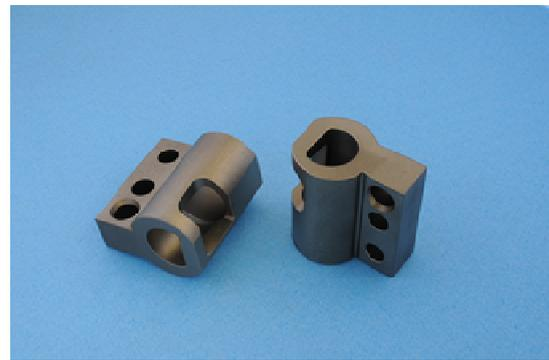
本製品は、PHEV（プラグイン・ハイブリッド）用に開発されたトランスミッションに用いられるパーキング部品であり、本製品のテーパ形状部に相手部品が乗り上がることによりパーキングギヤをロックさせます。
