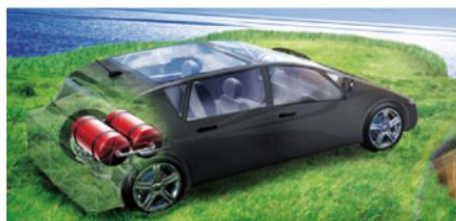
FCV車でのガスボンベ使用例
