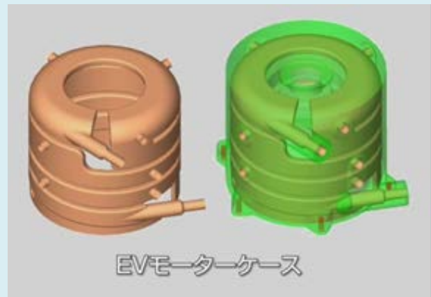
複雑形状の一体型砂鑄型の例
