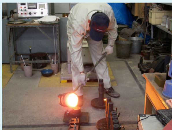
鋳造試験研究室（試験片作成の様子）
