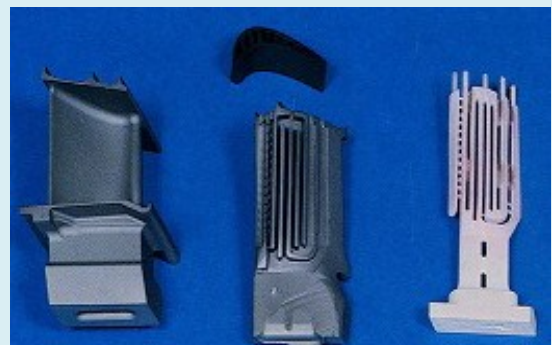
タービン動翼の内部構造 (提供: (株)IHI キャスティングス)
